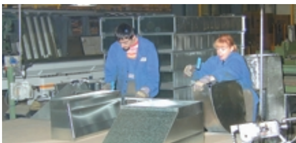
Herstellung von Kanälen und Formstücken ist immer noch ein Thema, denn Weger betreibt in der näheren Umgebung nach wie vor einen Lüftungsanlagenbau.
